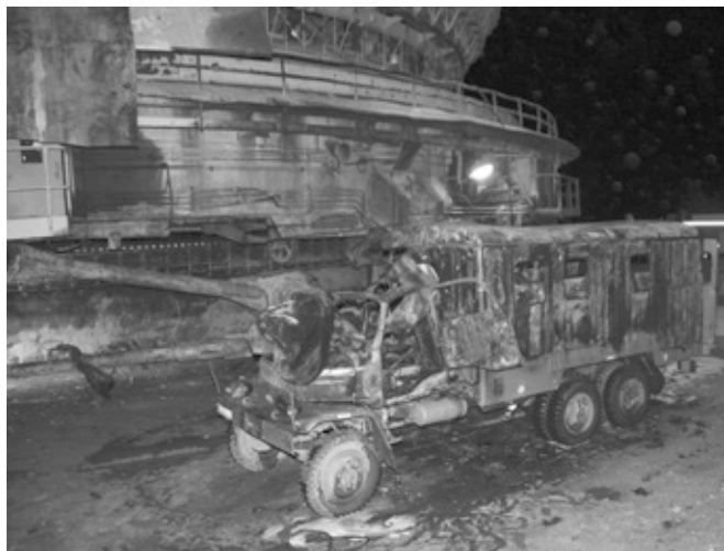
Obrázek 1 – Nákladní automobil se skříňovou nástavbou (pojízdná dílna) po uhašení požáru způsobeném závadou na autogenní soupravě
