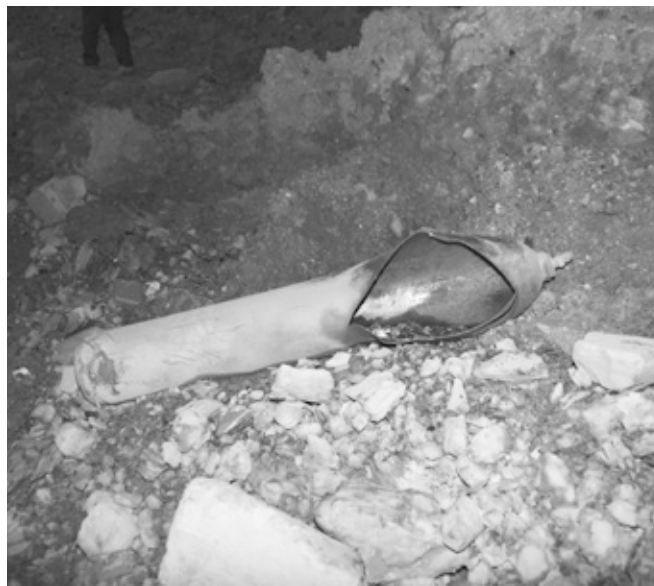
Obrázek 2 – Roztržená tlaková láhev nacházející se mimo místo skříňové nástavby, kde byla před mimořádnou událostí umístěna
